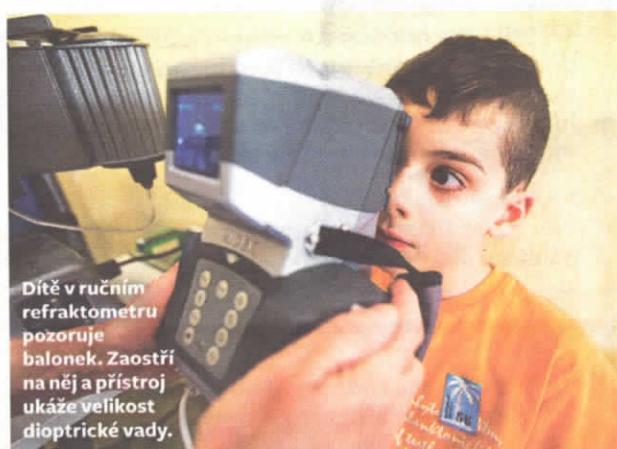
Dítě v ručním refraktometru pozoruje balonek. Zaostří na něj a přístroj ukáže velikost dioptrické vady.
